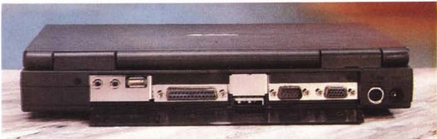
Sul retro, protetti da un unico grosso sportello, le solite uscite seriali, video, audio e stampante; da notare la presenza di una USB che diverrà presto la connessione principale delle periferiche.
